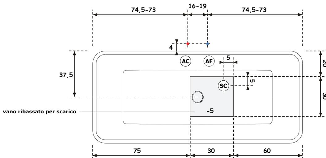
Allaccio acqua calda nel caso di vasca provvista di rubinetteria **AC** Hot water connection should the bathtub be fitted with taps
