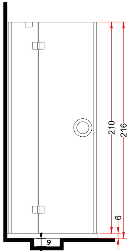
Alloggio piletta di scarico
