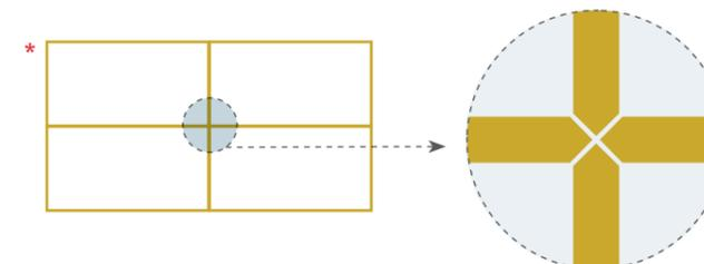
\* Este modelo de latón con acabado en flecha ha sido diseñado específicamente para las versiones rectificadas con el objetivo de enmarcar las piezas. This brass model with arrowhead has been designed specifically for rectified versions with the aim of framing the pieces.
