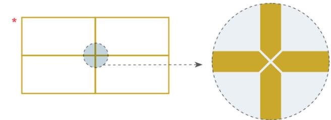
\* Este modelo de latón con acabado en flecha ha sido diseñado específicamente para las versiones rectificadas con el objetivo de enmarcar las piezas.
